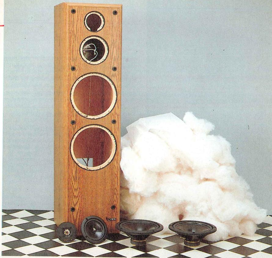
Aperto il mobile si scopre una quantità di assorbente acustico inusitata, capace di smorzare di molto la risposta dei woofer ed eliminare qualsiasi rimbombo.
